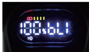
光量調整ボタン(+)と電源/調光ボタンを同時に約2秒間押しと、高速で点滅する。パディへの合図やナイトダイビング中のシグナルとして便利
