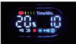
バッテリー残量が残りわずかになると自動的に20%まで光量を落とし、バッテリー状態の表示が点滅。[10min]が表示され、カウントダウンを開始
