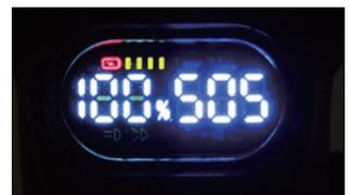
光量調整ボタン(-)と電源/調光ボタンを同時に約2秒間押しと救難要請信号SOSモードで点滅する
