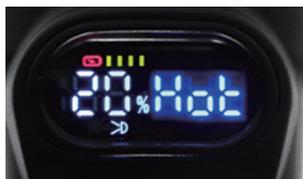
使用中にライトヘッドが55℃以上になると自動的に保護モードへ移行し、最大光量20%まで減光する
