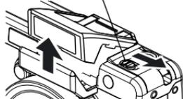
1 2Gカメラの電源をOFFにして、図1のように2Gカメラを本製品にセットする
