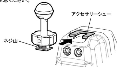
3 ロックナットを時計方向にまわして下部へ移動させ締め付ける
