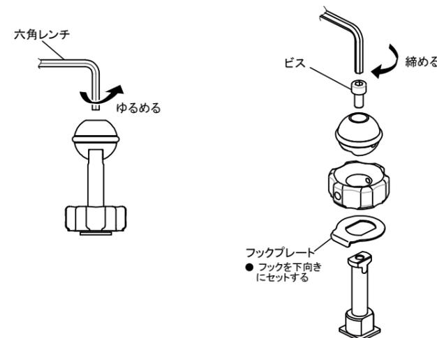
3 フックプレートをアクセサリシューへ引っ掛けて、ロックナットを時計方向にまわして締め付ける
