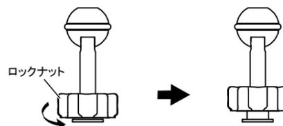
2 ロックナット下部のネジ山のある面をハウジングの正面に向けてアクセサリシューへスライドさせる
